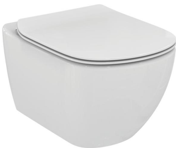
Vaso sospeso con fissaggi nascosti. Dotato di scarico a parete e sedile. Certificato per scarico 4,5/3 litri.
